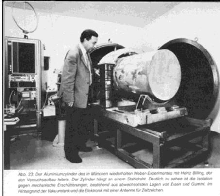
Abb. 23. Der Aluminiumzylinder des in München wiederholten Weber-Experimentes mit Heinz Billing, der den Versuchsablauf leitete. Der Zylinder hängt an einem Stahlstrahl. Deutlich zu sehen ist die Isolation gegen mechanische Erschütterungen, bestehend aus abwechselnden Lagen von Eisen und Gummi. Im Hintergrund der Vakuumtank und die Elektronik mit einer Antenne für Zeitrechnen.
