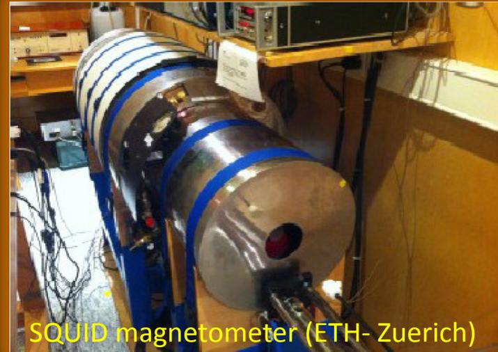
SQUID magnetometer (ETH- Zuerich)
